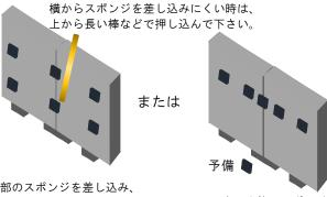
ECO パネル用スポンジ(背面用)は<左図>のように接続部分下部にもセットできるのが理想ですが下部にスポンジを設置するのが難しい場合は、 <右図>のように
