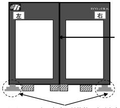
左右のパネルの間に隙間が出ないように設置して下さい。隙間があると音洩れが起こります。
