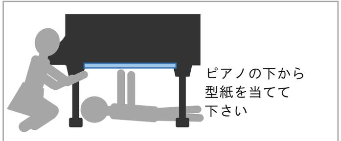
型紙は、鍵盤側と対抗側の双方が約 10mm 強小さく隙間があきます。
